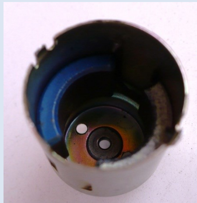
Stator – permanentní magnet
